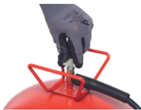
Girare la valvola bianca presente sulla bombola in senso antiorario, fino all'apertura. Non chiudere la valvola fino a che la bombola non è vuota (questo per evitare che si secchi l'adesivo nel tubo e nella pistola).
